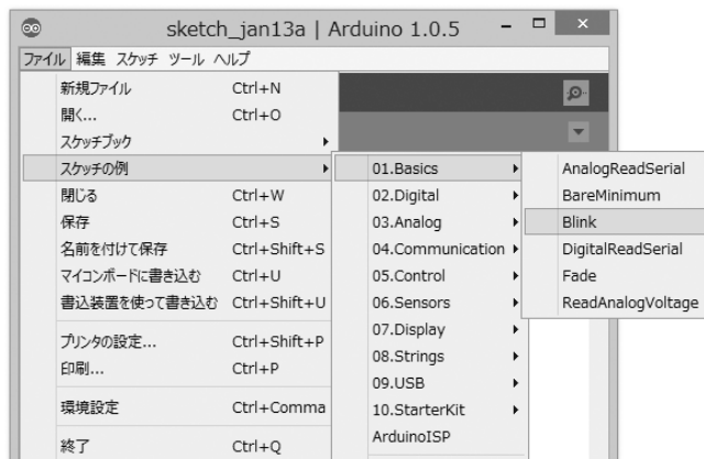
図2.2 サンプル・スケッチ「Blink」の読み込み
