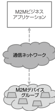
図1.2 M2M構成 (デバイス群が接続されるケース)
