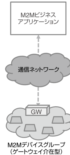
図1.3 M2M構成 (ゲートウェイが介在するケース)
